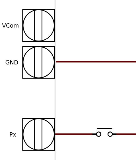
Figura 3: Diagramă conectare port ieșire modul
