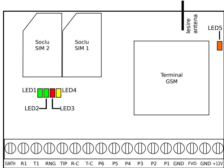
Figura 1: Diagrama de conectare a modulului rev. 5
