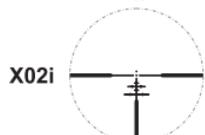
X02i Reticolo a forma di croce con dot illuminato e gradazione che permette una misurazione della distanza di un oggetto con dimensioni /spostamento d’aria/scala di alzo noti ( $x9 \times 12$ ).
