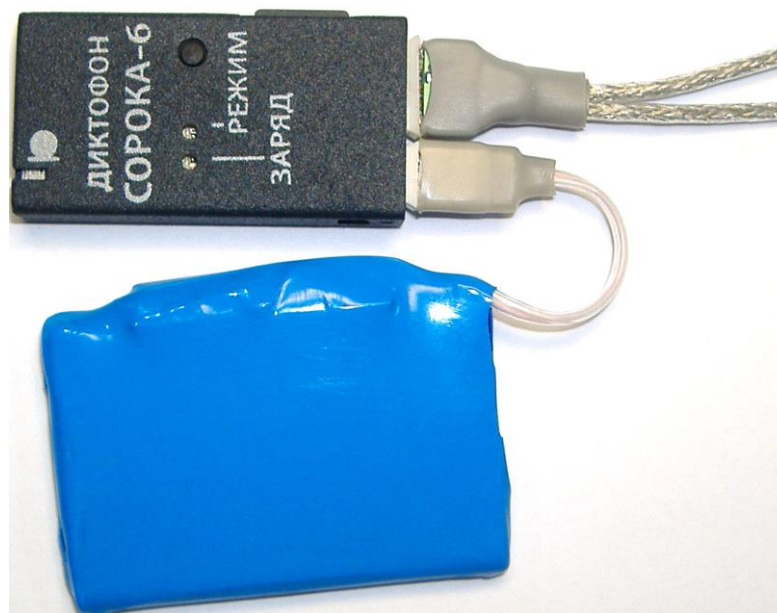
Fig. 7. Exemplu de funcționare a înregistratorului vocal „SOROKA-06E” cu un acumulator extern și microfoane stereo externe.
