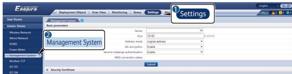
Figura 6-9 Setarea parametrilor sistemului de management
