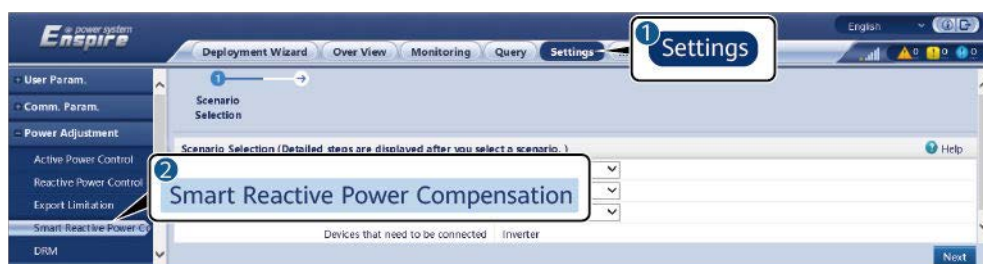
Figura 6-53 Setarea parametrilor pentru compensarea puterii reactive inteligente
