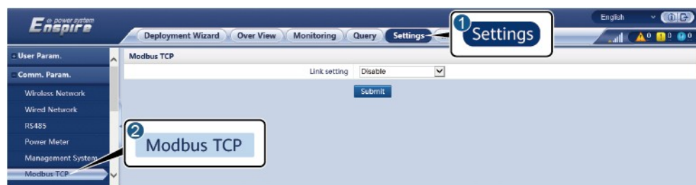
Figura 6-14 Setarea parametrilor Modbus TCP
