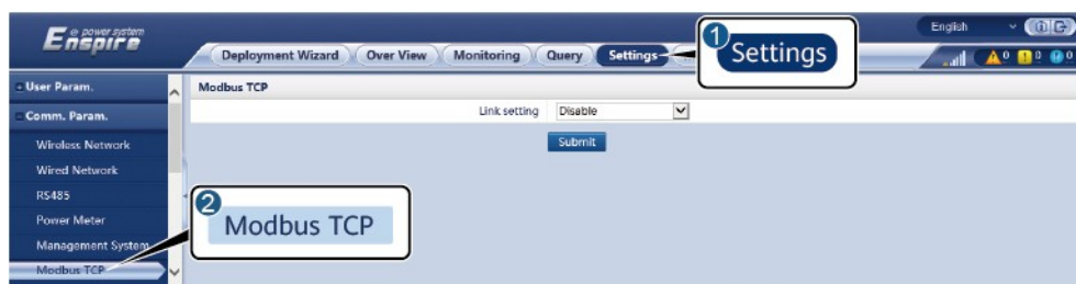
Figura 6-11 Setarea parametrilor Modbus TCP
