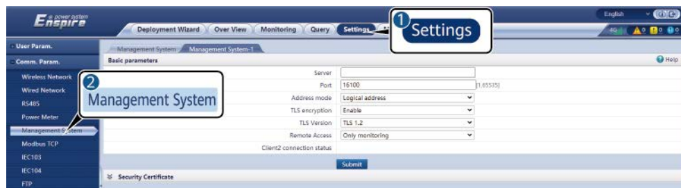
Figura 6-10 Setarea parametrilor sistemului de management
