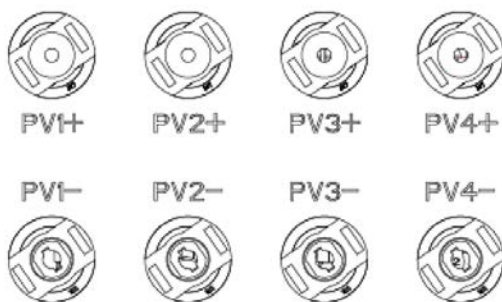
Figura 5-4 Bornele de intrare c.c.
