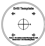
Figura 2-20 Șablon de foraj al cutiei de jonctiune
