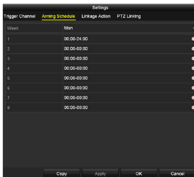
Figura 8–8 setarea programului de armare a intrării alarmei
