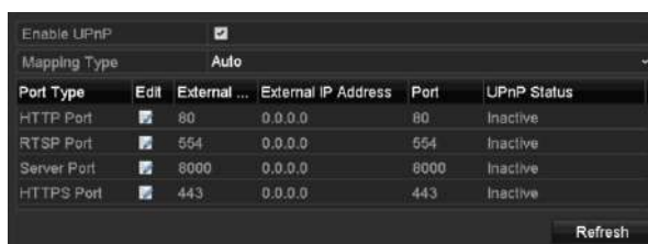
Figura 12–13 setări UPnP™ terminate-Automat
