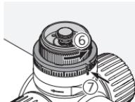
Placera markeringsringarna på tornet utifrån uppgifterna i det ballistiska programmet, och rikta in ringarna mot referenspunkten.
