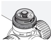
Sæt markeringsringene på tårnet i henhold til oplysningerne i det ballistiske program, og ret dem ind efter indekspunktet.
