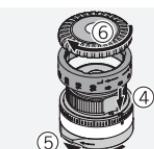
Asenna oikea/vasen asteikolla varustettu rengas. Varmista, että nolla on kohdistettu osoittimeen. Sulje lukitusmekanismi. Kierrä uritettu rengas takaisin torniin.
