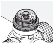
Plaats de markeringsringen op de toren, op basis van de gegevens in het ballistische programma, en stem ze af op het indexpunt.
