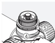
Öffnen Sie die Arretierung des Turms. Drehen Sie die Markierung am Turm auf Null, sollte er sich verdreht haben.
