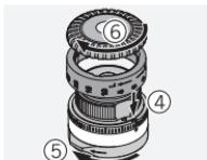
Montera höger/vänster skalring. Kontrollera att nollan överensstämmer med referenspunkten. Stäng låsmekanismen. Skruva på den räfflade ringen på tornet igen.
