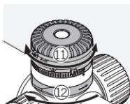
Ahora ya puede elegir la configuración que deseé. Gire el mecanismo de bloqueo un cuarto de vuelta en sentido horario para bloquearlo.
