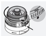
Gire la torreta 35 clics en sentido anti horario y alinee la marca >|< de la parte superior de la escala con el punto de referencia. Después, cierre el mecanismo de bloqueo.
