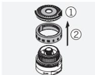
Kierrä uritettu rengas irti tornista. Irrota uritettu rengas ja asteikolla varustettu rengas ( tai merkkirenkaat).
