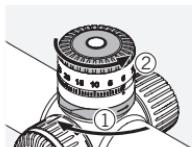
Compruebe el ajuste a cero de la torreta y bloquee el mecanismo de bloqueo. Desenrosque la anilla ranurada de la torreta.
