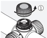
Nehmen Sie die Schraubkappe von der Höhenverstellung des Zielfernrohres ab.
