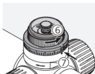
Setzen Sie die Markierungsringe anhand der Angaben im Ballistikprogramm auf den Turm und richten Sie diese am Indexpunkt aus.
