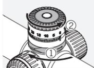
Kontrollér nulindstillingen på tårnet, og lås låsemekanismen. Skru drejeknappen af tårnet.
