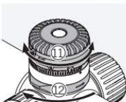
Vous pouvez maintenant sélectionner les réglages de votre choix. Tournez le mécanisme de blocage d'un quart de tour dans le sens des aiguilles d'une montre pour le bloquer.
