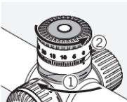
Проверьте нулевую настройку на турели и зафиксируйте механизм блокировки. Открутите от турели рифленое кольцо.
