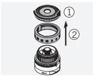
Schrauben Sie den Rändelring am Turm auf. Nehmen Sie nun den Rändelring und den Skalenring (oder die Markierungsringe) ab.
