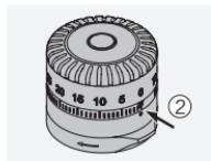
Установите маркировку на турели на нулевую отметку.
