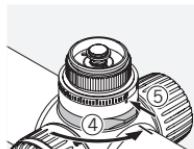
Ouvrez le mécanisme de blocage de la tourelle. Placez la marque de la tourelle sur zéro si elle s'est déplacée dans une autre position.
