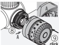
Setzen Sie den Turm seitlich auf bis ein Klickgeräusch zu hören ist.
