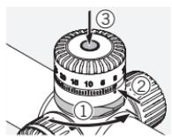
Open het vergrendelingsmechanisme van de toren. **Controleer de nulpositie.** Druk met een spits voorwerp in het midden van de toren.
