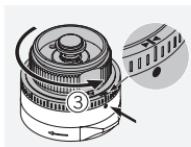
Drehen Sie den Turm 35 Klicks gegen den Uhrzeigersinn und bringen die  $>\langle$ -Markierung an der Oberseite der Skala mit dem Indexpunkt überein. Schließen Sie dann die Arretierung.
