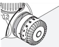
Drehen Sie die Arretierung zum Schließen um ein Viertel im Uhrzeigersinn.
