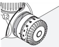
Gire el mecanismo de bloqueo un cuarto de vuelta en sentido horario para bloquearlo.
