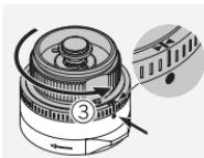
Ruotate la torretta di 35 clic in senso antiorario e allineate la tacca >|< sulla parte superiore della scala con l'indice di riferimento. Dopo di che chiudete il meccanismo di bloccaggio.
