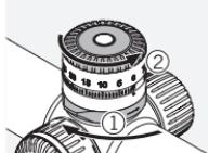
Kontrollieren Sie die Nullstellung des Turms und schließen Sie dann die Arretierung. Schrauben Sie den Rändelring am Turm auf.
