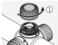
Verwijder het Schroefdeksel van de toren aan de bovenzijde van de richtkijker.
