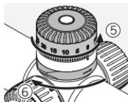
Du kan nu välja önskade inställningar på tornet. Vrid låsmekanismen ett kvarts varv medsols för att låsa den.
