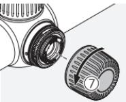
Rimuovete il tappo a vite sulla torretta laterale del cannocchiale.
