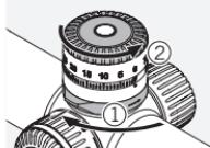
Kontrollera tornets nollinställning och lås låsmekanismen. Skruva loss den räfflade ringen från tornet.
