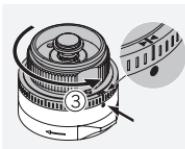
Draai de toren 35 klikken tegen de klok in en stem de >< markering aan de bovenzijde van de schaal af op het indexpunt. Zet vervolgens het vergrendelingsmechanisme vast.
