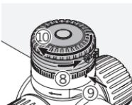
Når du har sat markeringsringene på tårnet, skal du skru drejeknappen på igen.
