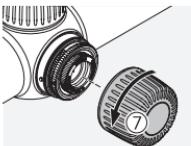
Nehmen Sie die Schraubkappe am Seitenturm des Zielfernrohres ab.
