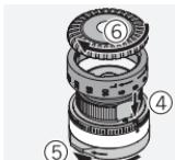
Installez la bague graduée droite/gauche. Assurez-vous que le point zéro est aligné avec le point de référence. Refermez le mécanisme de blocage. Vissez la bague moletée sur la tourelle.
