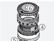
Installate l'anello graduato destro/sinistro. Assicuratevi che lo zero sia allineato con l'indice di riferimento. Chiudete il meccanismo di bloccaggio. Riavvitate l'anello zigrinato sulla torretta.
