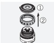
Skru drejeknappen af tårnet. Afmonter drejeknappen og skalaringen (eller markeringsringene).
