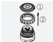
Skruva loss den räfflade ringen från tornet. Ta bort den räfflade ringen och skalringen (eller markeringsringarna).
