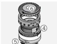
Setzen Sie den Skalenring nach rechts/links auf. Beachten Sie dabei, dass die Null mit dem Indexpunkt übereinstimmt. Schließen Sie die Arretierung. Anschließend wird der Rändelring am Turm zugeschraubt.
