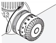
Ruotate il meccanismo di blocco di un quarto in senso orario per bloccarlo.
