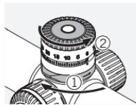
Vérifiez que la tourelle est bien réglée sur zéro, puis bloquez le mécanisme de blocage. Dévissez la bague moletée et retirez-la de la tourelle.
