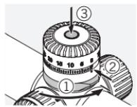
Aprite il meccanismo di bloccaggio sulla torretta. **Controllate la posizione zero.** Con un oggetto appuntito, esercitate una pressione nel centro della torretta.
