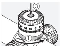
Откройте механизм блокировки на турели. **Проверьте нулевую позицию.** Используя остроконечный предмет, нажмите в центре турели.
