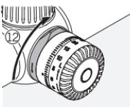
Tournez le mécanisme de blocage d'un quart de tour dans le sens des aiguilles d'une montre pour le bloquer.
