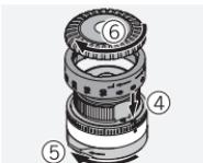
Plaats de schaalverdelingsring rechts/ links. Zorg ervoor dat de nul overeenstemt met het indexpunt. Zet het vergrendelingsmechanisme vast. Draai de kartelring weer vast op de toren.
