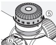
Vous pouvez maintenant sélectionner les réglages de votre choix sur la tourelle. Tournez le mécanisme de blocage d'un quart de tour dans le sens des aiguilles d'une montre pour le bloquer.
