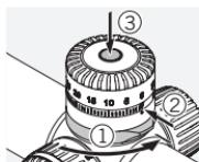
Åbn tårets låsemekanisme. **Kontrollér nulpositionen.** Brug en skarp genstand til at trykke midten af tåret ind.
