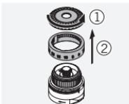
Dévissez la bague moletée et retirez-la de la tourelle. Retirez la bague moletée et la bague graduée (ou les bagues de repérage).
