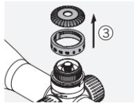
Retirez la bague moletée et la bague graduée.
