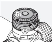
Après avoir installé les bagues de repérage sur la tourelle, réinstallez la bague moletée.
