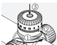
Öffnen Sie die Arretierung des Turms. **Überprüfen Sie die Nullposition.** Drücken Sie mit einem spitzen Gegenstand in die Mitte des Turms.
