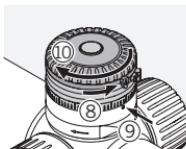
När du har placerat markeringsringarna på tornet skruvar du på den räfflade ringen igen.
