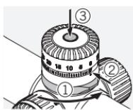
Ouvrez le mécanisme de blocage de la tourelle. **Vérifiez la position zéro.** À l'aide d'un objet pointu, appuyez au centre de la tourelle.
