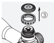
Irrota uritettu rengas ja asteikolla varustettu rengas.
