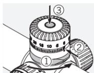
Öppna låsmekanismen på tornet. **Kontrollera nolläget.** Tryck i mitten av tornet med ett spetsigt föremål.
