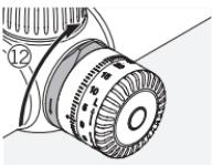
Поверните механизм блокировки на четверть оборота по часовой стрелке, чтобы зафиксировать его.
