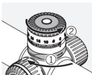
Controleer de nulinstelling van de toren en zet het vergrendelingsmechanisme vast. Draai de kartelring van de toren los.
