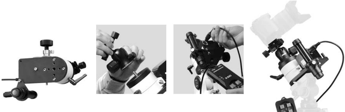
**HINWEIS! Dieser Abschnitt behandelt die Montage der Foto-Montierung auf einem speziell dafür konzipierten Stativ mit Polwiege. Wenn die Foto-Montierung auf ein bereits vorhandenes Stativ montiert werden soll, lesen Sie auch die zugehörige Anleitung.**
