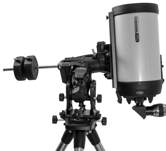
Figure 6 Équilibrage de la monture
