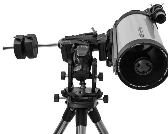
Figure 9.2 Un côté du limiteur DEC matériel
