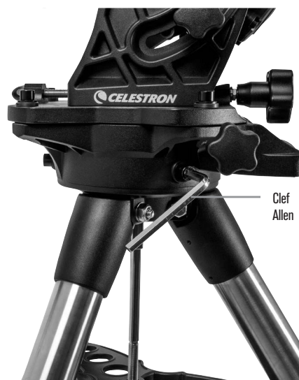
Figure 3 Fixer la monture à votre trépied
