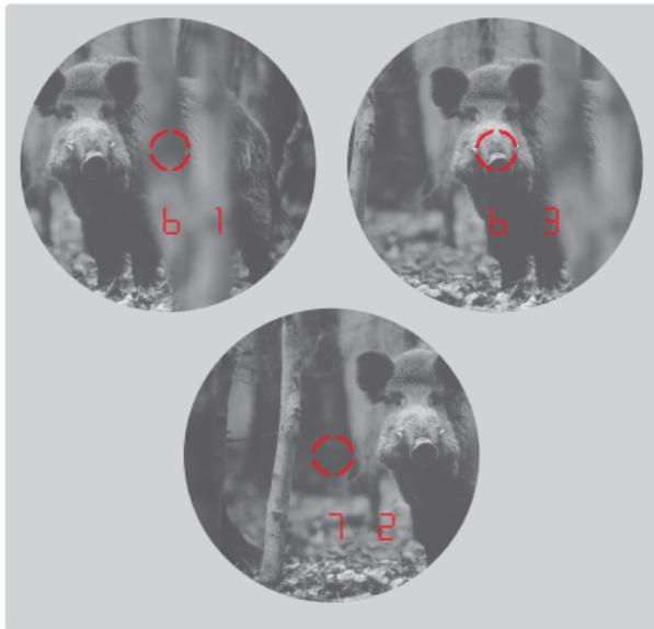
Mit dem Leica Rangemaster kann auch im Dauerbetrieb (Scan-Betrieb) gemessen werden: Halten Sie die Haupttaste **2** bei der zweiten Betätigung gedrückt. Nach ca. 2,5 s schaltet sich das Gerät in den Scan-Betrieb und führt dann permanent Messungen durch. Zu erkennen ist dies an der wechselnden Anzeige. Nach
