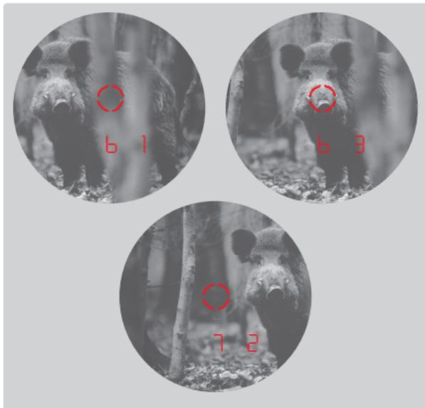
Le Leica Rangemaster permet également d'effectuer des mesures en continu (mode Scan) :
