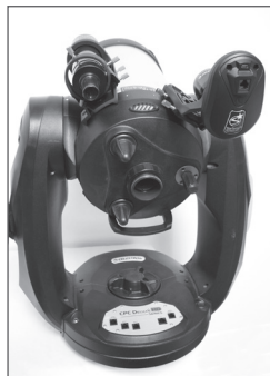
Cercatore e StarSense installati su CPC 800
