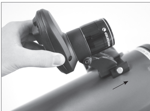
Installation du petit support (arrière vers avant)
