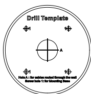
Figura 2-20 Șablon de foraj al cutiei de joncțiune
