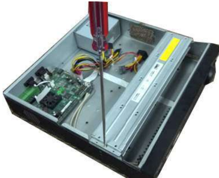
Figura 3-36 Deschideți capacul superior
