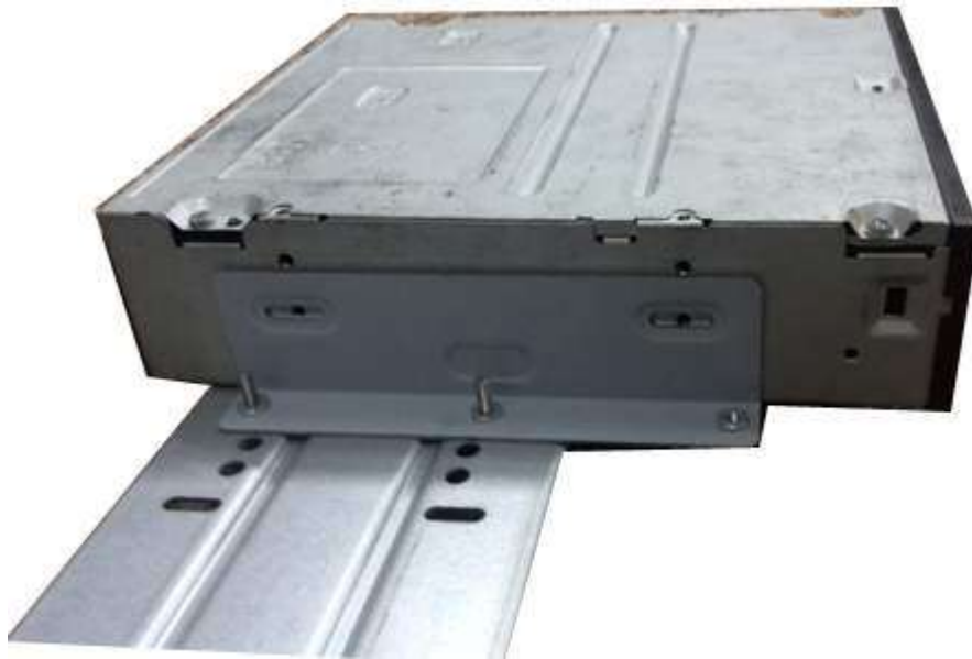
Figura 3-42 Instalați arzătorul SATA
