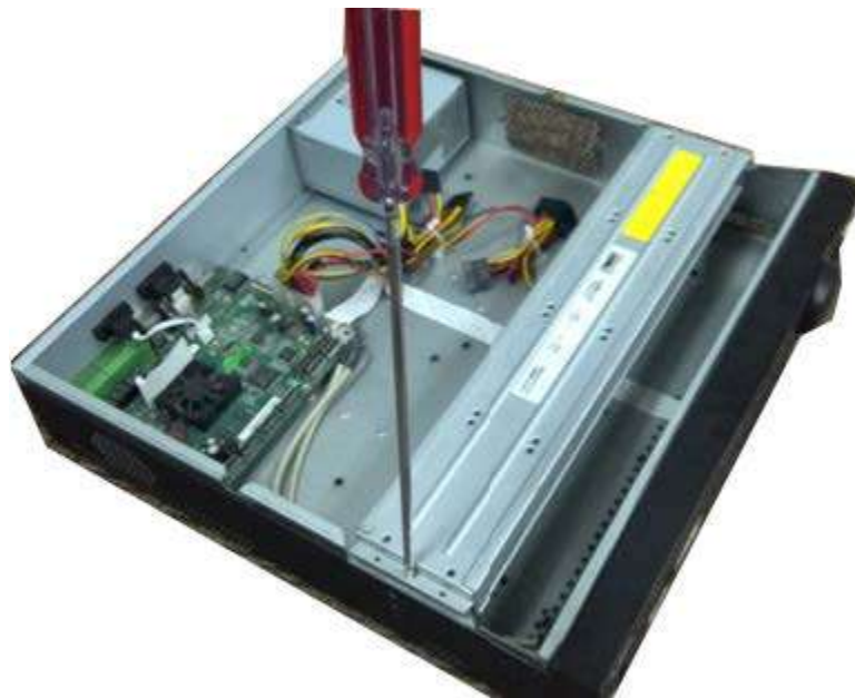
Figura 3-37 Deschideți capacul superior
