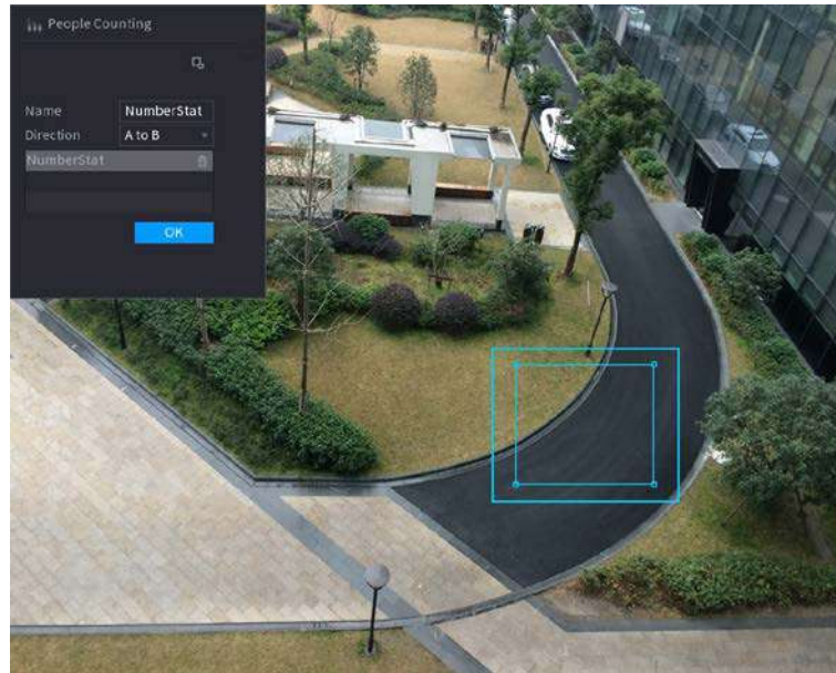
Figura 5-177 Numărarea persoanelor (filtrare țintă)
