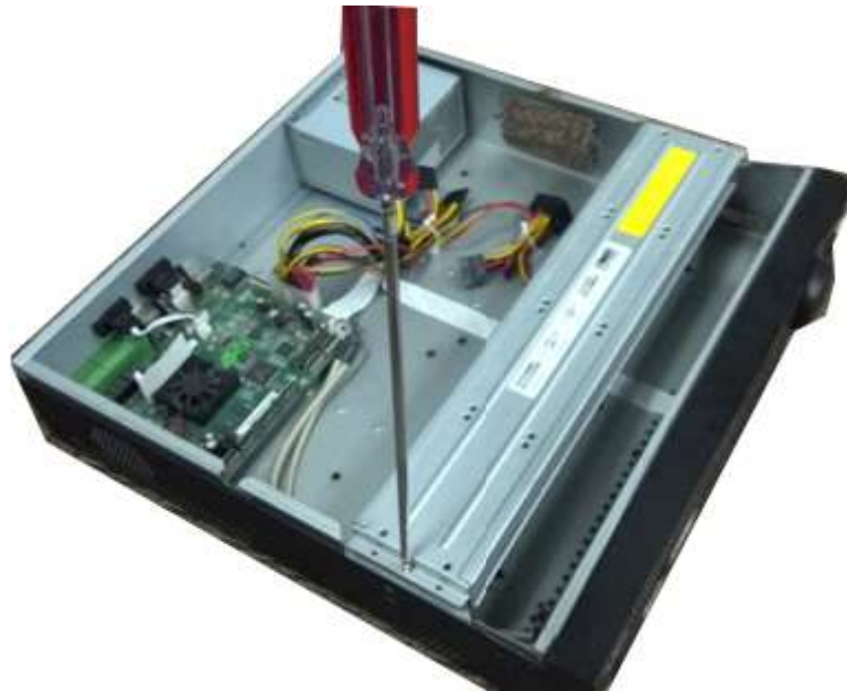
Figura 3-37 Deschideți capacul superior
