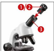
Steek nu het kleinste oculair, in dit geval de WF10x (1) in de oculairbuis (3).
