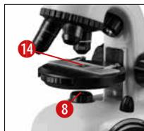
Leg nu een houdbaar preparaat (14) direct onder het objectief op de microscooptafel. Het te observeren object dient hierbij precies boven het lampje (8) te liggen.
