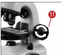
Breng de microscooptafel (7) helemaal naar beneden (11). Draai vervolgens de objectiefrevolver (4) zo ver door, dat hij op de laagste vergroting (objectief 4x) vastklikt.
