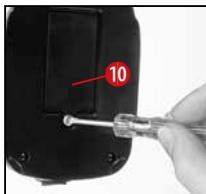
Nella base del microscopio si trova il vano batterie (10). Aprire delicatamente il coperchio del vano batterie.
