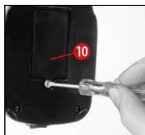
In de voet van de microscoop bevindt zich het batterijvak (10). Verwijder de schroef op het deksel van het batterijvak met een geschikte kruisschroevendraai-
