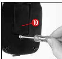
Im Fuß des Mikroskops befindet sich das Batteriefach (10). Die Schraube am Batteriefachdeckel mit einem geeigneten Kreuzschraubendreher entfernen und Batteriefachdeckel abnehmen.
