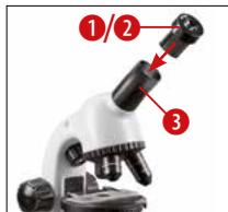
Setze nun das kleinste Okular, in dem Fall das WF10x (1) in den Okularstutzen (3) ein.
