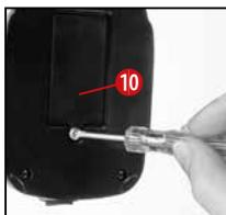
Au pied du microscope se trouve le compartiment à piles (10). Desserrez la vis au couvercle du compartiment à piles avec un petit tournevis Philips et retirez le couvercle. Place les batteries dans les compartiments de sorte que le pôle moins (-) plat des piles s'appuient contre les bornes à ressorts et que le pôle plus (+) des piles touchent ensuite les contacts-tôles plates. Ferme le compartiment à piles avec le couvercle et retourne le microscope.
