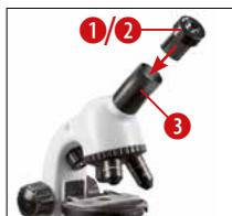
Insérez maintenant le plus petit oculaire, dans ce cas le WF10x (1) dans la supports d'oculaire (3).
