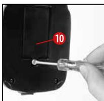
El compartimento de las pilas (10) se encuentra en el pie del microscopio. Desenrosque los tornillos de fijación del compartimento de la batería con un destornillador Phillips pequeño y retire la cubierta. Introduce ahora las pilas en las cámaras de modo que los polos negativos lisos (-) de las pilas presionen los sujetadores de muelle y los polos positivos (+) de las pilas entren en contacto con la chapa lisa. Cierra el compartimento de las pilas con la tapa y vuelve a girar el microscopio.
