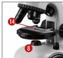
Nun lege ein Dauerpräparat (14) direkt unter dem Objektiv auf den Mikroskopisch. Das zu beobachtende Objekt soll hierbei genau über der Beleuchtung (8) liegen.
