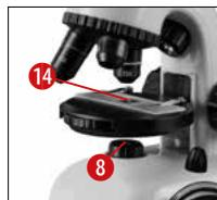
Maintenant, pose une préparation durable (14) directement sous l'objectif sur la table du microscope. L'objet à observer ne doit pas être placé directement sur l'éclairage (8).
