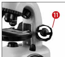
Em primeiro lugar, desloca (7) a mesa do microscópio (11) totalmente para baixo. Em seguida, gira o revólver das objectivas (4) até encaixar na ampliação mais reduzida (objectiva 4x).
