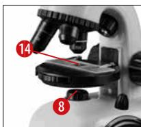
Ahora coloca una preparación permanente (14) en la mesa del microscopio directamente bajo el objetivo. Para ello, el objeto a observar debe estar colocando exactamente sobre la iluminación (8).
