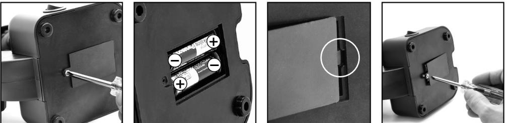
Pour l'observation de la source de lumière électronique (6), vous devez insérer deux piles AA 1.5V, dans le compartiment de la batterie (8) sur la base du microscope (7). Le compartiment des piles est ouvert à l'aide d'un tournevis cruciforme. Insérez les piles avec la polarité (+/- d'indication). Mettez le couvercle de la batterie en premier dans la petite ouverture pour que le couvercle s'adapte parfaitement. Maintenant, vous pouvez serrer la vis.
