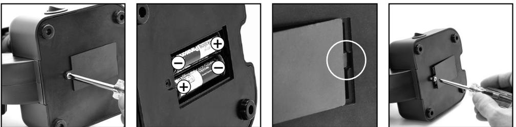
Para la observación con la fuente de luz electrónica (6) necesita insertar 2 AA pilas de 1.5V, en el compartimento de las pilas (8) en la base del microscopio (7). El compartimento de las pilas se abre usando un destornillado Phillips. Inserte las pilas con la polaridad correcta (+/- indicación). Coloque primero la tapa de las pilas en la pequeña abertura para que la tapa encaje perfectamente. Ahora puede apretar el tornillo.
