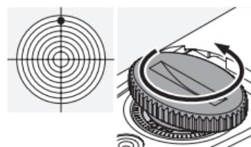
b) ... en cas d'impact haut, dans le sens inverse des aiguilles d'une montre conformément à la valeur de correction du point d'impact (1/4 MOA par clic ; 7 mm sur 100 m).
