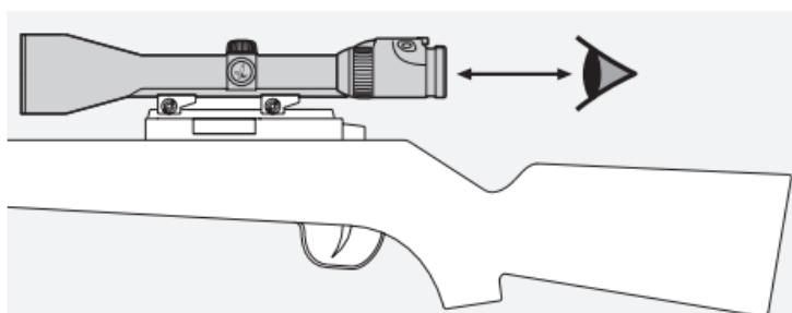
Tenez compte de la distance oculaire imposée si une lunette de visée est installée sur l'arme (voir fiche signalétique technique pour les mesures).
