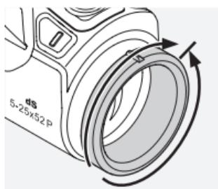
Girando semplicemente il compensatore di diottrie è possibile effettuare una regolazione individuale ottenendo così un'ottimale nitidezza del reticolo. Girare dapprima il compensatore di diottrie completamente verso sinistra (in senso antiorario) e poi verso destra, finché il reticolo non mostrerà la nitidezza ottimale. Una volta che il reticolo è nitido, anche il display lo sarà.
