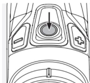
Dès que vous appuyez sur le bouton de mesure, un cercle lumineux apparaît, le repère de cible pour la mesure de la distance, et la fonction de mesure est activée. Si vous relâchez
