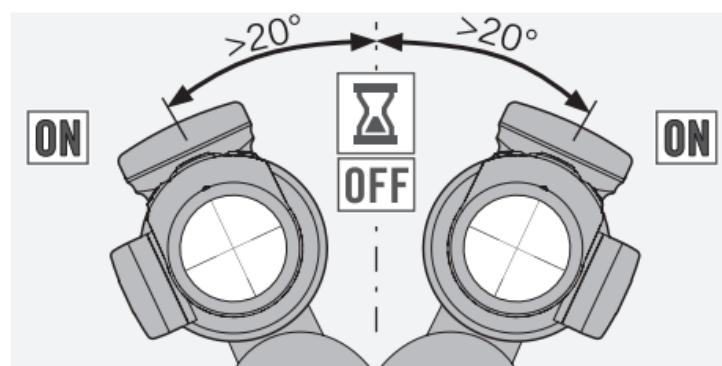
Efter 40, 60 eller 80 sekunder (tiden kan indstilles forud i appen) slukkes sigteilluminationen og displayet. 10 sekunder forinden vises et advarselssymbol. For at forlænge varigheden af displayvisningen med den indstillede tid skal der trykkes plus- eller minusknappen, eller dS skal vippes mindst 20 grader mod højre eller venstre. Når displayet er gået ud, skal det aktiveres til en ny måling, ved at man trykker på måleknappen.
