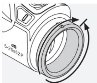
Uw individuele instelling voor de beste scherpte van het dradenkruis bereikt u eenvoudig door de dioptriestelring te verdraaien. Draai de dioptriestelring eerst helemaal naar links (tegen de wijzers van de klok in) en dan naar rechts, tot het dradenkruis optimaal scherp is. Als het dradenkruis is scherpgesteld, dan is het display dat ook.
