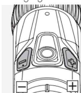
Une fois l'éclairage du réticule allumé, vous pouvez maintenant régler la luminosité au moyen de la touche +/- et sélectionner le niveau souhaité entre 64 niveaux de luminosité. Pour obtenir la luminosité optimale, maintenez la touche enfoncée (impulsion continue), et pour effectuer le réglage de précision, appuyez une fois sur la touche (impulsions brèves).
