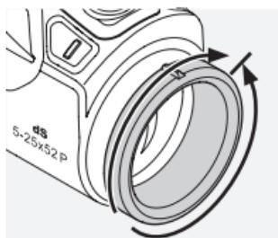
Para enfocar según su visión personal sólo tiene que girar el anillo de corrección de dioptrías. Gire primero el anillo de corrección ajuste de dioptrías completamente hacia la izquierda - en el sentido contrario de las agujas del reloj - y luego hacia la derecha hasta que la imagen quede enfocada de manera óptima. Si la imagen está enfocada, la pantalla también lo está.
