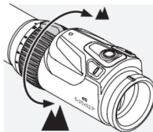
En tournant la bague de réglage du grossissement à 180°, vous obtenez graduellement le grossissement de votre choix. La graduation oblique permet de lire le réglage facilement et aisément. Pour faciliter l'orientation, le revêtement souple et rainuré de la bague de réglage est doté d'un taquet. Lorsque le grossissement est modifié, la position du point de visée et des repères de dérive s'adapte quasiment simultanément.
