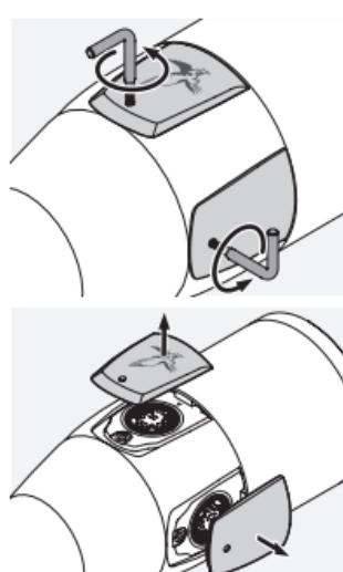
2. Locken på höjd- och sidoinställningarna kan skruvas av med den medlevererade torx-nyckeln (TX 6). När de är öppna kan höjd- och sidoinställningen justeras med inställningsverktyget.
