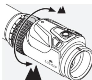
Ved at dreje forstørrelsesringen  $180^\circ$  kan den ønskede forstørrelse indstilles trinløst. Skalaen på forstørrelsesringen muliggør en nem og komfortabel aflæsning af indstillingen. For at lette orienteringen har det bløde, riflede overtræk på forstørrelsesringen en fingerknop. Når forstørrelsen ændres, tilpasser sigtepunktets og vindmarkeringernes position sig samtidigt.
