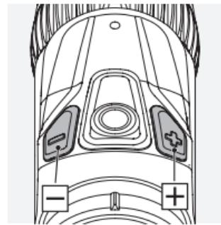
Una volta che l'illuminazione del reticolo è accesa, è possibile regolare la luminosità mediante i tasti +/- e selezionando l'impostazione desiderata fra 64 livelli di luminosità. Per individuare rapidamente la luminosità ottimale è possibile tenere premuto il pulsante (impulso continuo), mentre premendolo singole volte (impulso singolo) è possibile effettuare una regolazione di precisione.
