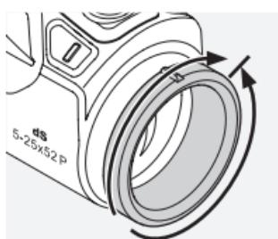
Индивидуальная настройка резкости прицельной марки выполняется путем обычного поворота маховика диоптрийной настройки. Сначала поверните маховик диоптрийной
