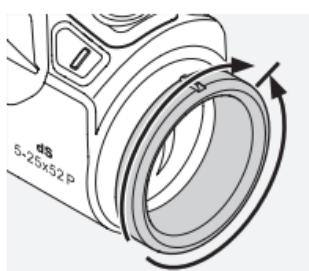
Din individuelle indstilling til opnåelse af optimal skarphed for sightet kommer i stand ved en enkel drejning af dioptrijusteringsringen. Drej først dioptri-justeringsringen helt til venstre (mod uret) og derefter til højre, indtil sightet viser optimal skarphed. Når sightet er stillet skarpt, er displayet også stillet skarpt.
