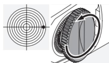
b) ... en cas d'impact vers la droite, dans le sens inverse des aiguilles d'une montre conformément à la valeur de correction du point d'impact (1/4 MOA par clic ; 7 mm sur 100 m).
