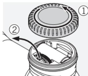
1. Aprire il coperchio della batteria, quindi prendere il cacciavite Torx e l'utensile di regolazione.
