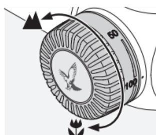
С помощью барабанчика прицельная марка оптимально фокусируется на объект на любом удалении, при этом исключается погрешность вследствие параллакса.
