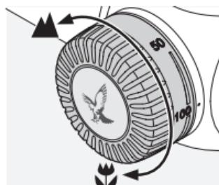
Mit dem Parallaxeturm können Sie die optimale Schärfe für jede Zielentfernung einstellen und Zielfehler durch Parallaxe vermeiden. Die Parallaxeeinstellung kann von 50 m bis unendlich vorgenommen werden.
