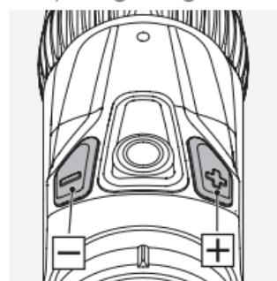
När hårkorsbelysningen är tänd, kan man justera ljusstyrkan med +/- knapparna, och välja bland 64 ljusstyrkenivåer. För att snabbt finna optimal ljusstyrka kan man hålla knappen intryckt (lång impuls), med enkla tryckningar (korta impulser) görs fininställningen.
