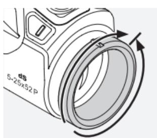
Käännä diopterinkorjaussäätöä korjataksesi mahdollisen silmävirheen. Käännä ensin diopterinkorjaussäätöä ääriasentoon vasemmalle (vastapäivään) ja sitten oikeaan kunnes ristikko on täysin tarkentunut. Kun ristikko säädetty teräväksi, myös kuva on tervä.
