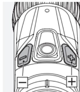
После включения подсветки прицельной марки можно настроить яркость с помощью кнопок «+/-», а также выбрать режим подсветки из 64 доступных уровней яркости. Для быстрой настройки оптимальной яркости можно удерживать кнопку нажатой (длительный импульс), точная настройка осуществляется кратким нажатием кнопки (единичный импульс).
