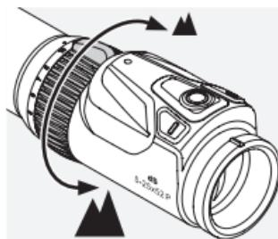
Girando l'anello di regolazione dell'ingrandimento di 180° è possibile regolare l'ingrandimento a piacimento. La scala sull'anello di regolazione consente una facile e comoda lettura della regolazione. Per consentire un migliore orientamento, il morbido rivestimento scanalato dell'anello di regolazione è provvisto di una sporgenza. Se l'ingrandimento viene modificato, anche la posizione del punto di mira e delle tacche di deriva cambia quasi contemporaneamente.
