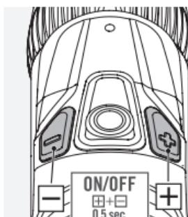
Pour allumer l'éclairage du réticule (réseau de nuit), appuyez simultanément sur les boutons plus et moins pendant une demi-seconde. Vous pouvez aussi appuyer seulement sur le bouton plus ou seulement sur le bouton moins pendant une demi-seconde.
