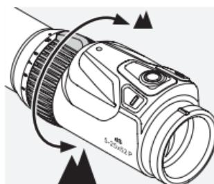
Durch Drehen des Vergrößerungsstellrings um bis zu  $180^\circ$  können Sie die gewünschte Vergrößerung stufenlos einstellen. Die Skala am Stellring ermöglicht ein einfaches und komfortables Ablesen der Einstellung. Zur besseren Orientierung besitzt der weiche, gerippte Stellringüberzug eine Nase. Ändert sich die Vergrößerung, passt sich die Position des Haltepunkts und der Windfäden nahezu zeitgleich an.
