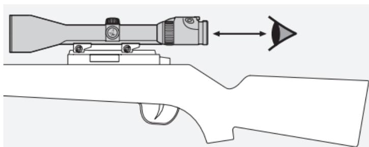
Vær opmærksom på den angivne udgangspupilafstand for riffelsigtet, som er monteret på våbnet (mål, se databladet).
