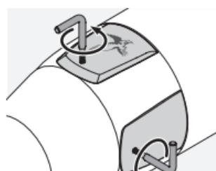
2. Die Abdeckungen der Höhen- und Seitenverstellung lassen sich mit dem beigefügten Torxschlüssel (TX 6) aufdrehen. Im geöffneten Zustand können Sie dann mit dem Stellwerkzeug die Höhen- und Seitenverstellung vornehmen.
