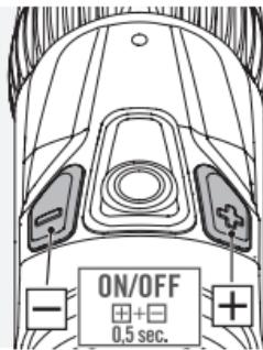
Voor inschakelen van de dradenkruisverlichting (nachtdradenkruis) drukt u gelijktijdig de plus-en min-knop een halve seconde in. U kunt ook de plus- of min-knop elk apart een halve seconde indrukken.
