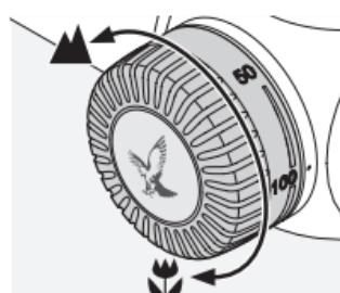
Med parallaksetårnet kan du indstille den optimale skarphed for enhver afstand til målet og forhindre sigtefejl på grund af parallakse. Parallaksetårnet kan indstilles fra 50 m til uendelig.
