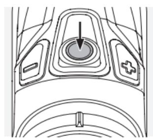
När man trycker på mätknappen visas en ljuscirkel, målmarkering för avståndsmätning, och mätfunktionen aktiveras. När man släpper mätknappen utlöses mätningen och siktpunkten, som beräknas med utgångspunkt från dina inmatade data, visas. Målmarkeringen är den centrala siktpunkten i det fysiska riktmedlet.
