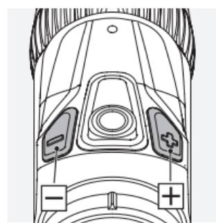
Kun hiusristikoni valo on sytynyt, voit säätää kirkkautta +/- -painikkeella ja valita haluamasi asetuksen 64 kirkkaustasosta. Optimaalisen kirkkauden nopeaan löytämiseen painiketta voidaan pitää painettuna (kestopulssi), suorita hienosäätö painikkeiden kertapainalluksella (yksittäispulssi).
