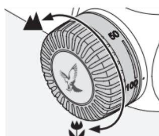
Con la torreta de paralaje podrá ajustar la nitidez óptima para cualquier distancia al objetivo y evitar el error de puntería por paralaje. La torreta de paralaje se puede ajustar de 50 m a infinito.
