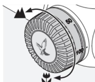
Con la torretta parallasse è possibile regolare la nitidezza ottimale per qualsiasi distanza di puntamento evitando così errori di mira dovuti a parallasse. La torretta di parallasse può essere impostata da 50 m all'infinito.
