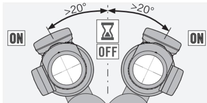
Na 40, 60 of 80 seconden (tijdsduur instelbaar in de app) schakelen de dradenkruisverlichting en het display uit. 10 seconden daarvoor verschijnt een waarschuwingssymbool. Voor verlenging van de weergave met de ingestelde tijdsduur, moet de + of - knop worden ingedrukt of de dS minstens 20 graden naar links of rechts worden gekanteld. Als het display is uitgeschakeld, moet ter activering de meetknop voor een nieuwe meting worden ingedrukt.
