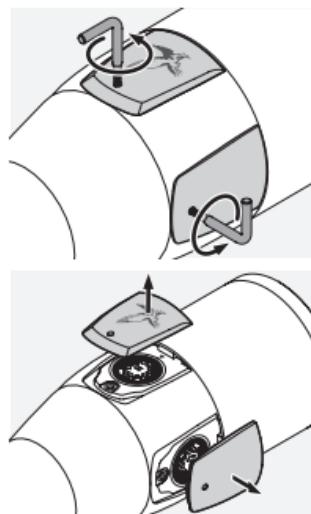
2. Крышки механизмов коррекции по высоте и боковой коррекции отвинтите с помощью прилагаемой отвертки Torx (TX 6). После этого при открытых крышках с помощью установочного инструмента выполните коррекцию по высоте и боковую коррекцию.
