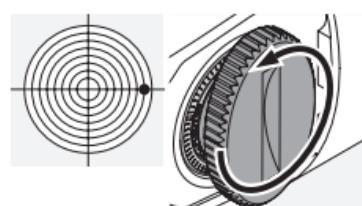
b) ... bei einem Rechtschuss gegen den Uhrzeigersinn entsprechend der Treffpunktkorrektur (pro Klick 1/4 MOA; 7 mm auf 100 m).
