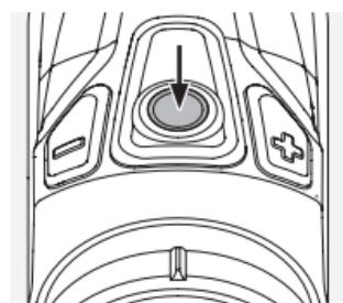
Si pulsa el botón de medición, aparecerá un círculo iluminado y se activará la función de medición. Si suelta el botón de medición, la medición comenzará y aparecerá el punto de impacto, calculado en base a los datos introducidos. La marca de medición es el punto de impacto central de la retícula física.
