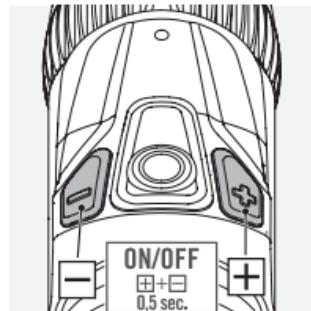
Для включения подсветки прицельной марки (прицельной марки ночного видения) одновременно нажмите кнопку «плюс» и «минус» и удерживайте их нажатыми в течение полсекунды. Или же
