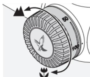
Met de parallax-toren kunt u de optimale scherpte voor elke richtafstand instellen en richtfouten door parallax vermijden. De parallax-instelling op de parallax-toren kan vanaf 50 m tot oneindig worden ingesteld.
