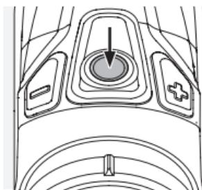
Painaessasi mittauspainiketta, tulee etäisyyssmittauksen tähtäysrengas, valoymppyrä näkyviin ja mittausstoiminto käynnistyy. Kun mittauspaineike vapautetaan, mittaus suoritetaan ja annettuihin tietoihin perustuva tähtäyspiste ilmestyy. Ristikön keskuspiste on mittauspiste josta tähtäyspiste mitataan. Laite mittaa tarkan etäisyyden ja näyttää säädetyn suurennoksen, ilmanpaineen, lämpötilan ja kulman laskennan avulla automaattisesti ja heti tarkan tähtäyspisteen.
