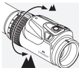
Путем поворота маховика фокусировки на  $180^\circ$  плавно изменяется кратность увеличения. Благодаря наклонной шкале на маховике фокусировки
