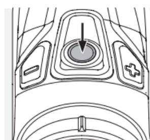
Premendo il pulsante di misurazione compare un cerchio luminoso, il bersaglio per la misurazione della distanza, e viene attivata la funzione di misurazione. Quando si rilascia il pulsante, comincia la misurazione. Compare quindi il punto di mira calcolato sulla base dei dati inseriti. Il segno di misurazione misurazione è il punto di mira centrale del reticolo fisico.
