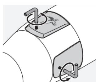
2. De afdekkingen van de hoogte- en breedteverstelling zijn met de meegeleverde torx-schroevendraaier (Tx 6) los te draaien. In geopende toestand kan vervolgens met het gereedschap de hoogte en breedteverstelling worden uitgevoerd.
