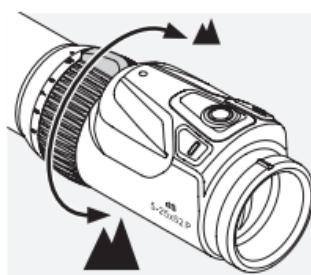
Door de vergrotingsstelring  $180^\circ$  te draaien kunt u de gewenste vergroting traploos instellen. De schaal op de stelring maakt een eenvoudig en praktisch aflezen van de instelling mogelijk.
