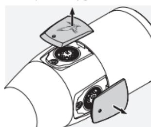
3. Hoogteverstelling: Draai met het gereedschap naar het midden van de hoogteverstelling...
