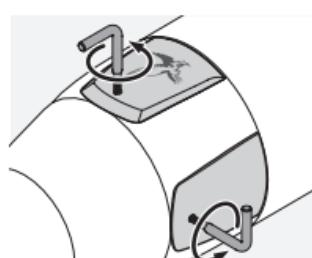
2. Vous pouvez ouvrir les caches des réglages vertical et latéral à l'aide du tournevis Torx (TX 6) joint. Lorsqu'ils sont ouverts, vous pouvez alors effectuer les réglages vertical et latéral avec l'outil de réglage.
