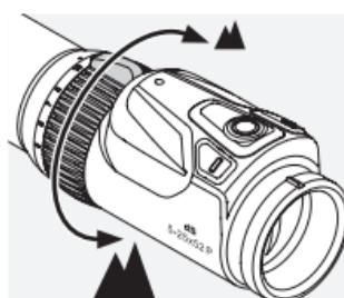
Genom att vrida ringen på förstoringen  $180^\circ$  kan du steglöst ställa in önskad förstoring. Skalan på ringen gör det enkelt och bekvämt att avläsa inställningen. För
