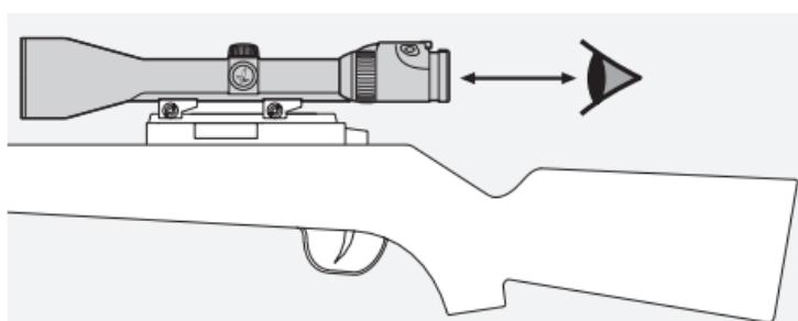
Prestare attenzione alla distanza interpupillare pre-definita in caso di cannocchiale da puntamento montato sull'arma (per le misure, vedere il manuale con dati tecnici).
