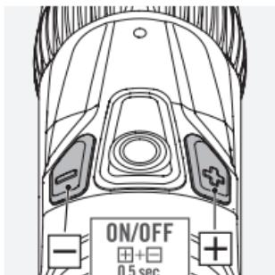
Drücken Sie zum Einschalten der Absehensbeleuchtung (Nachtabsehen) gleichzeitig die Plus- und Minustaste eine halbe Sekunde lang. Alternativ können Sie entweder nur die Plus- oder nur die Minustaste eine halbe Sekunde lang drücken.
