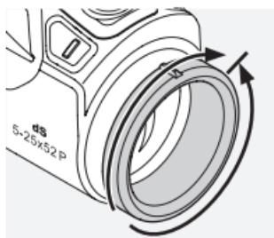
Pour obtenir l'image la plus nette du réticule, il vous suffit de tourner la bague de réglage de la dioptrie. Tournez la bague de réglage de la dioptrie entièrement vers la gauche (dans le sens inverse des aiguilles d'une montre) puis vers la droite, jusqu'à ce que le réticule soit le plus net possible. L'afficheur est également net lorsque le réglage de netteté du réticule est effectué.
