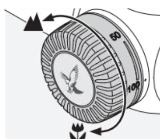
Med parallaxtornet kan du ställa in den optimala skärpan på alla avstånd och därmed undvika siktfel på grund av parallax. Parallaxtornet kan ställas in från 50 meter till oändligt.
