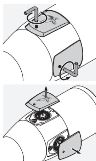
2. Svitare i cappucci della regolazione laterale e dell'altezza con il cacciavite Torx (TX 6) in dotazione. Una volta aperti, è possibile procedere alla regolazione laterale e dell'altezza con l'utensile di regolazione.
