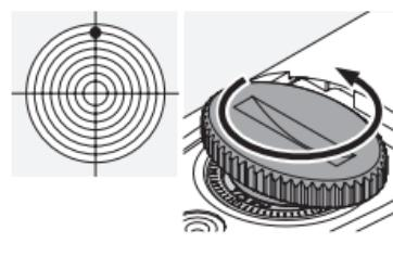
b) ... bei einem Hochschuss gegen den Uhrzeigersinn entsprechend der Treffpunktkorrektur (pro Klick 1/4 MOA; 7 mm auf 100 m).
