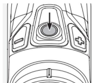
Wenn Sie die Messstaste drücken, erscheint ein Leuchtkreis, die Zielmarke für die Entfernungsmessung, und die Messfunktion wird aktiviert. Lassen Sie die Messstaste los, wird die Messung ausgelöst und der Haltepunkt, der sich anhand Ihrer eingegebenen Daten berechnet, erscheint. Die Messmarke ist der zentrale Haltepunkt des physischen Absehens.
