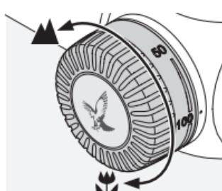
La tourelle de parallaxe vous permet d'effectuer des réglages d'une précision optimale pour toutes les distances d'objectif et d'éviter les erreurs d'objectif dues à la parallaxe. La tourelle de parallaxe peut être réglée de 50 m à l'infini.
