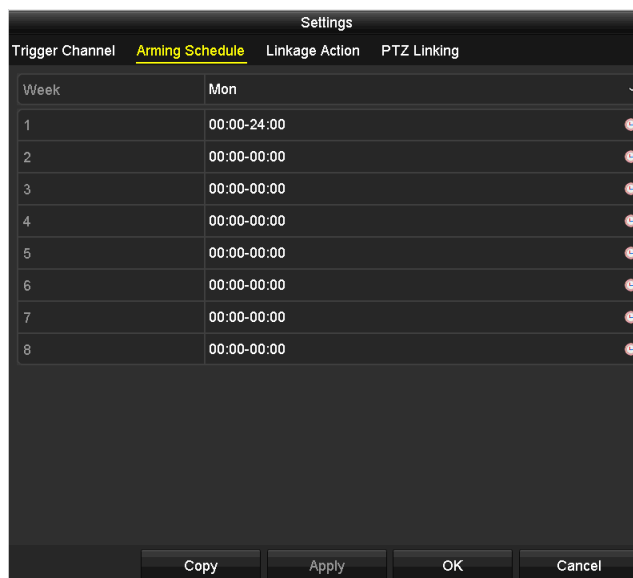
Figura 8-8 Setarea programului de armare a intrării alarmei
