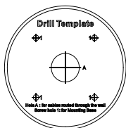
Figura 2-20 Șablon de foraj al cutiei de joncțiune
