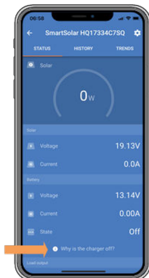
VictronConnect - link către „motivul pentru care încărcătorul este oprit”
