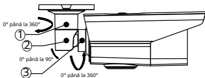
Figura 2-3 Reglare pe 3 axe
