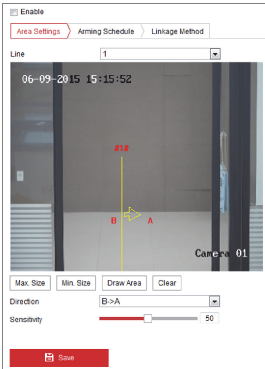
Figura 10–20 Detectare traversare linie
