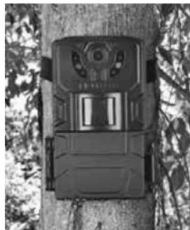
1. Verwenden Sie den Montagegurt um die Kamera an z.B. einen Baum zu befestigen.
