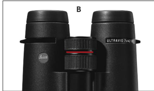
Met een van beide ringen wordt dan de betreffende kijker op een object scherp gesteld. Vervolgens met de andere ring de tweede kijker op optimale scherpte ingesteld. De volgorde kan willekeurig worden gekozen. Door de dioptriering naar beneden te drukken, wordt de ingestelde waarde opgeslagen. De ingestelde waarde is gemakkelijk op de nauwkeurige schaal af te lezen.
