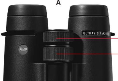
Mit einem der beiden Ringe wird dann das jeweilige Rohr auf ein Objekt scharf gestellt. Anschließend wird an dem anderen Ring das zweite Rohr auf optimale Schärfe eingestellt. Die Reihenfolge kann beliebig gewählt werden. Durch Herunterdrücken des Dioptrienrings wird der eingestellte Wert gespeichert. Der jeweils eingestellte Wert lässt sich bequem an der präzisen Skala ablesen.
