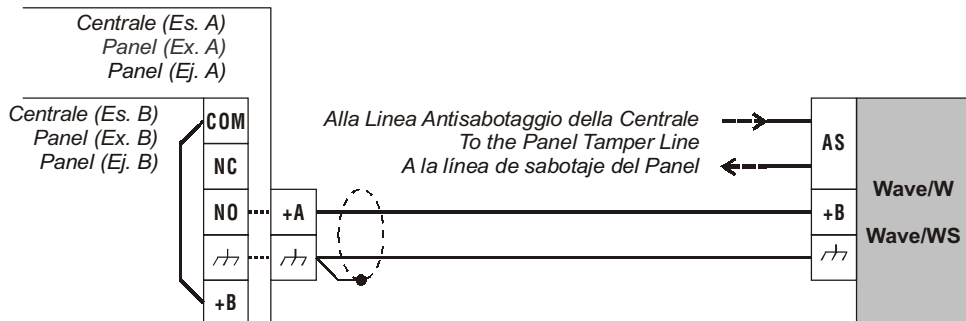
Fig. 4 - ① Esempio di collegamento della sirena Wave/W o Wave/WS Ⓞ Connection of Wave/W or Wave/WS ② Ejemplo de conexión para activar la sirena Wave/W o Wave/WS
