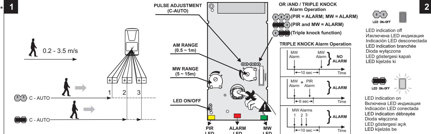
TEST \* TECT \* PRUEBA \* TEST \* WALK TEST \* ALGILAMA TESTİ \* TESZT
