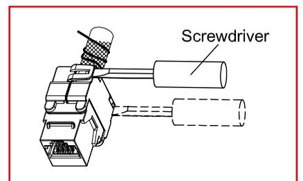
Um das Gehäuse zu öffnen, drücken Sie einen kleinen Schraubenzieher in die Kerbe der Verriegelung.
