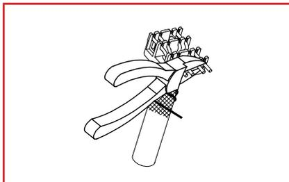
Schneiden Sie die überstehende Ader so nahe wie möglich an der Außenkante der Aderaufnahme ab.
