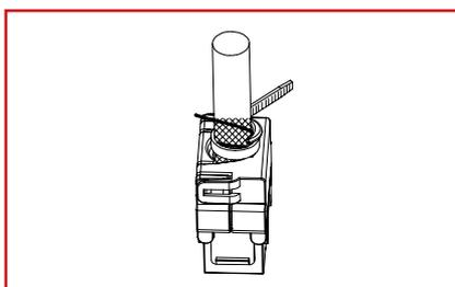
Fixieren Sie den Beidraht und den Schirm mit einem kleinem Kabelbinder. Bei Bedarf die Überstände des Schirmes oberhalb des Kabelbinders vorsichtig radial abschneiden ohne dabei den Kabelmantel zu verletzen.
