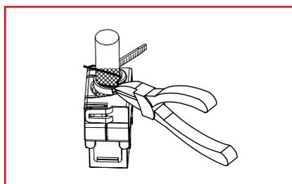
Schneiden Sie den Kabelbinder ab. Beidraht und Schirm dürfen dabei nicht abgeschnitten oder beschädigt werden.
