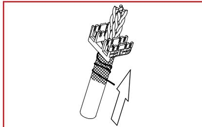
Adernpaare durch das Loch der Aderaufnahme führen und entsprechend dem gewünschten Farbcode ausrichten.
