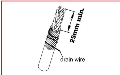
Entfernen Sie vom Kabelende mindestens 25 mm des Kabelmantels. Ziehen Sie die Schirmfolie oder das Schirmgeflecht über den Kabelmantel und wickeln den Beidraht wie dargestellt um den Schirm. Bei Folienschirm ist darauf zu achten, dass die leitende Folienseite aussen ist.
