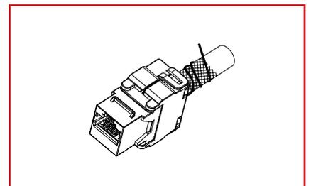
Stellen Sie sicher, dass der Beidraht um das Kabel und den Schirm gewickelt ist.
