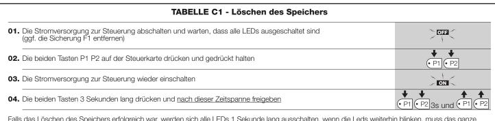
Falls das Löschen des Speichers erfolgreich war, werden sich alle LEDs 1 Sekunde lang ausschalten, wenn die Leds weiterhin blinken, muss das ganze Speicherlöschverfahren wiederholt werden.
