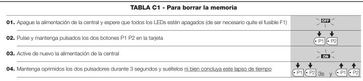
Si la memoria se hubiera borrado correctamente, todos los leds se apagarán durante un segundo; si los leds siguen destellando, habrá que repetir todo el procedimiento de borrado de la memoria.
